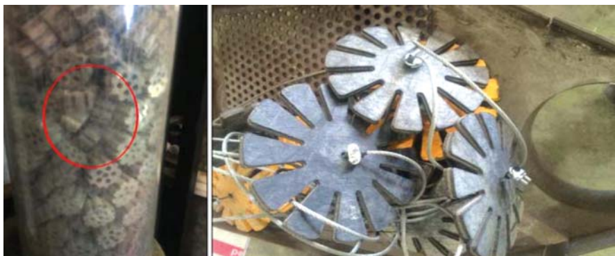
شکل ۵: پره‌های لاستیکی کاهنده سرعت در روش بارگذاری سنتی حفرات به وجود آمده پس از شارژ کاتالیست ریفرمینگ احیاء مستقیم (شکل سمت چپ)
