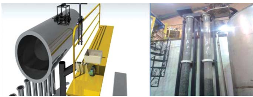
شکل ۶: بارگذاری کاتالیست‌های ریفرمینگ به روش مکانیزه
