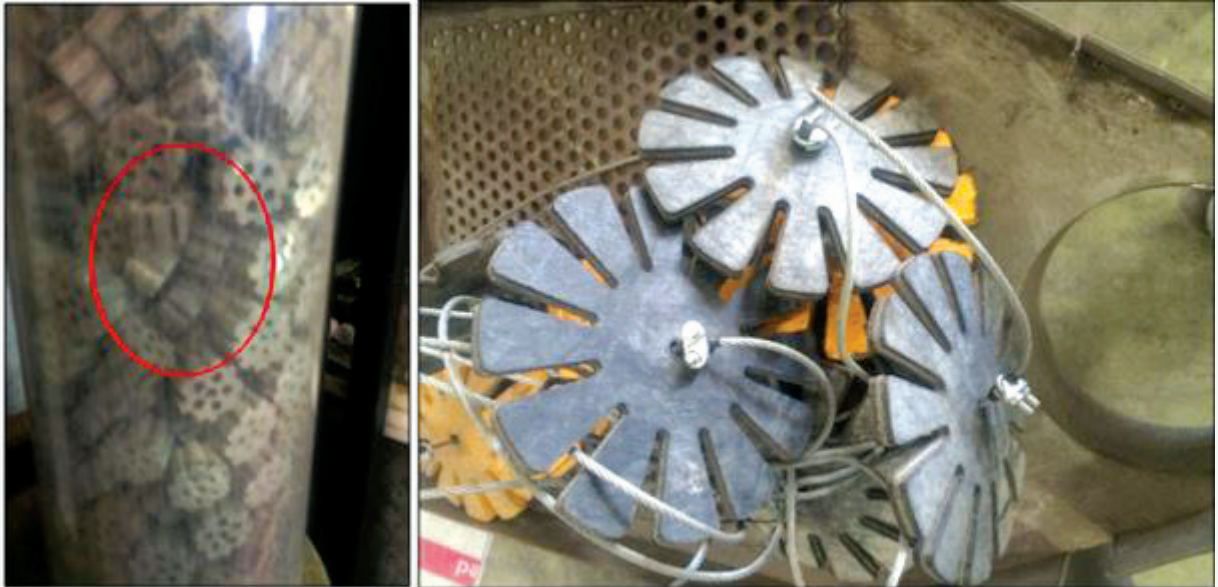
شکل ۵: پره های لاستیکی کاهنده سرعت در روش بارگذاری سنتی - حرقات بوجود آمده پس از شارژ کاتالیست ریفرمینگ احیاء مستقیم (شکل سمت چپ)
