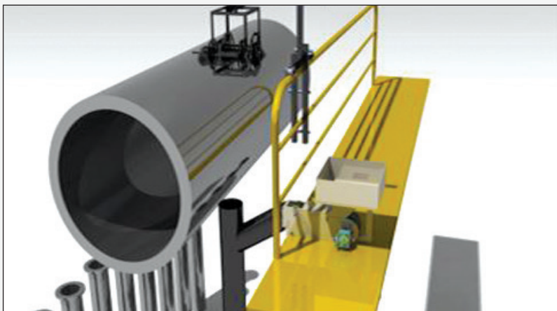
شکل ۶- بارگذاری کاتالیست های ریفرمینگ به روش مکانیزه
