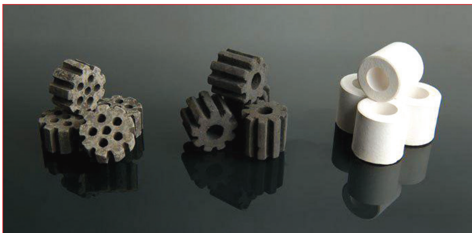
شکل ۱. تصویر کاتالیست خنثی (راست)، نیمه فعال (وسط) و فعال (سمت چپ) مورد استفاده در ریفرمر مدول ۱ شرکت فولاد خوزستان.
