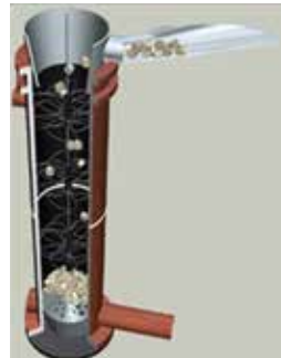
شکل ۱: روش بارگذاری متراکم یکنواخت: سمت راست (بارگذاری مخازن سولفورزادایی)، سمت چپ (بارگذاری تیوب های ریفرمر)
