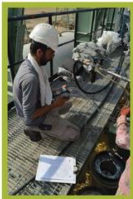
شکل ۴: تست افت فشار دو سر تیوب ها
