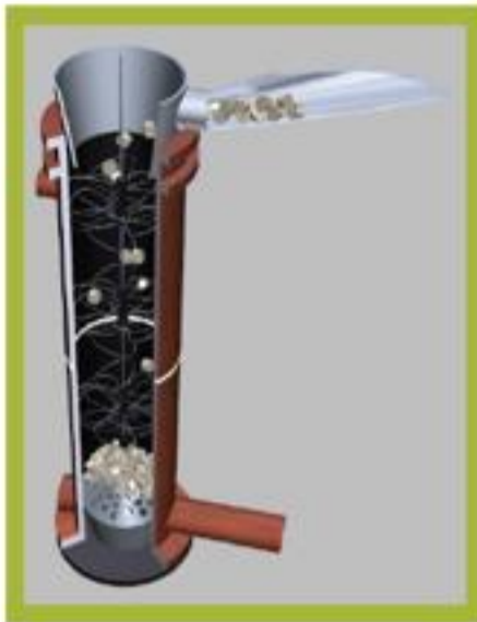
شکل ۱: روش بار گذاری متراکم یکنواخت: سمت راست (بار گذاری مخازن سولفورزدایی)، سمت چپ (بار گذاری تیوب های ریفرمر)
