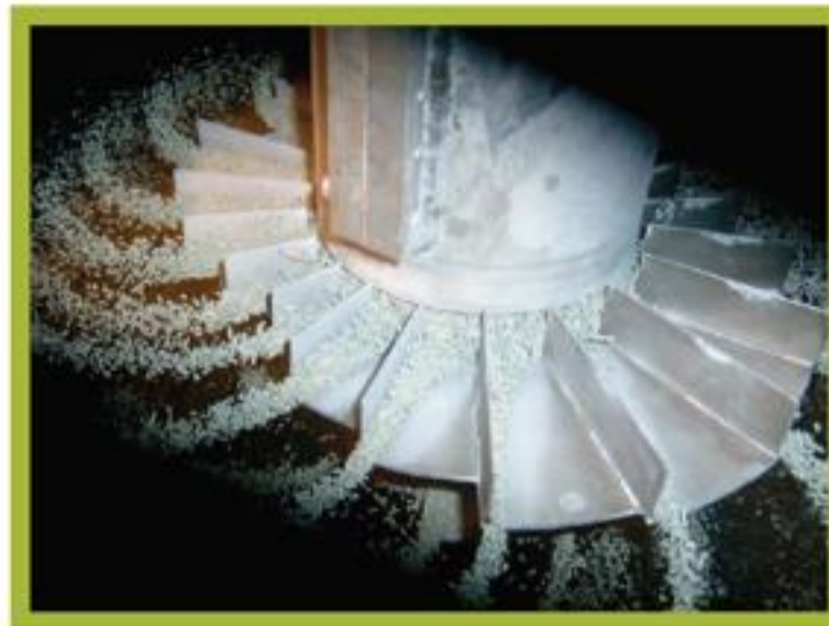
شکل ۱: روش بار گذاری متراکم یکنواخت: سمت راست (بار گذاری مخازن سولفورزدایی)، سمت چپ (بار گذاری تیوب های ریفرمر)
