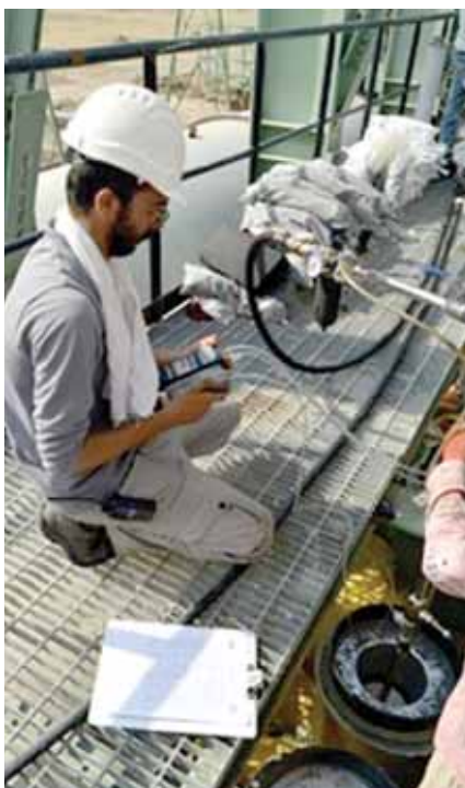
تست افت فشار دو سر تیوب‌ها
