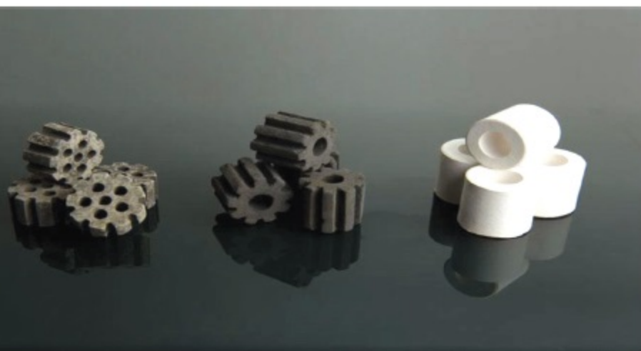
شکل ۱- تصویر کاتالیست خنثی (سمت راست)، نیمه فعال (وسط) و فعال (سمت چپ) مورد استفاده در ریفرمر مدول ۱ شرکت فولاد خوزستان
